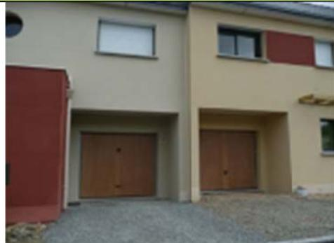
Les revêtements de l'enclave privative de stationnements pourront être perméables sur plus de 50% de la surface. Des revêtements type gravillons, pavés, dalles sont recommandées. L'imperméabilisation peut être limitée aux bandes de roulement. Les joints des pavés ou des dalles peuvent être engazonnés.
