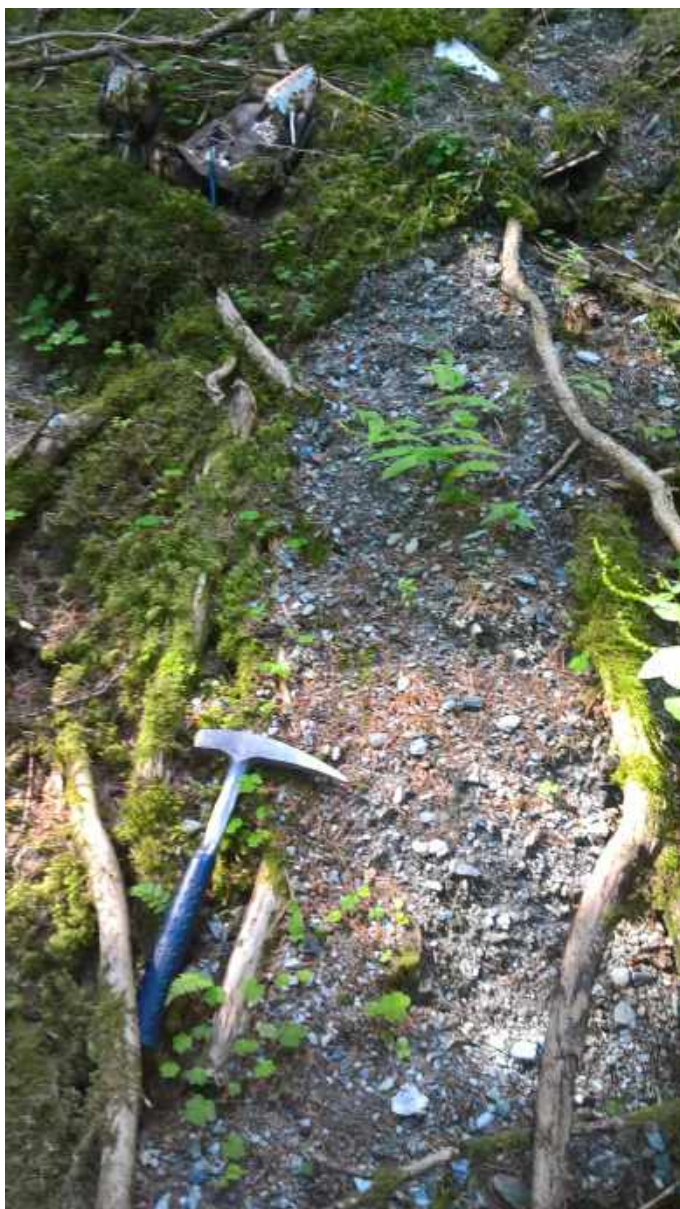
Photo 3 : coulée de matériaux déposés par le ruissellement sur la pente à une trentaine de mètres en amont du captage des Leissières..
