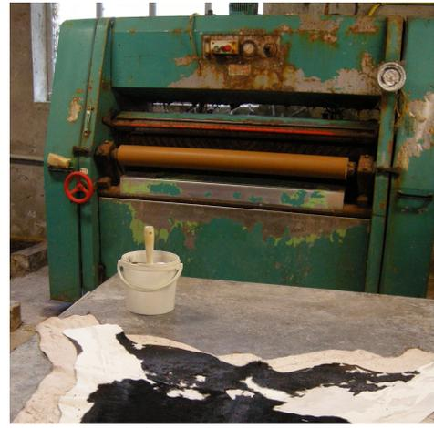
**L'écharnage** : une machine, munie de rouleaux qui grattent, écharne les peaux.
