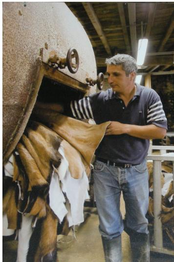
Plus besoin de pilons pour battre les cuirs. Deux grands tambours rotatifs les préparent. Le premier (**le foulon**) les dégraisse, les assouplit et les lisse avec un ajout de sciure de bois blanc; l'autre (**la roue**) se charge de faire tomber toutes les saletés en battant les peaux.
