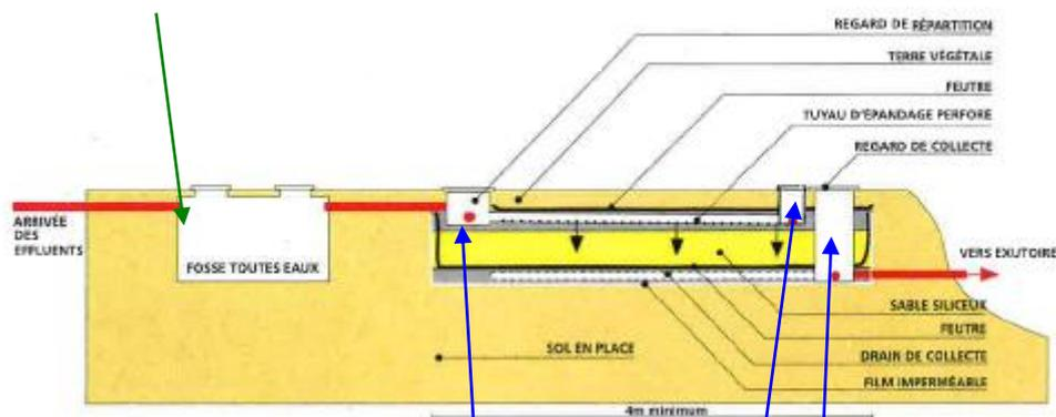
Coupe longitudinale : schéma de principe
