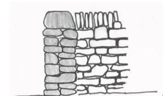
Vues de face et profil d'un mur avec couvertines
