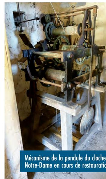
Mécanisme de la pendule du clocher de Notre-Dame en cours de restauration.
