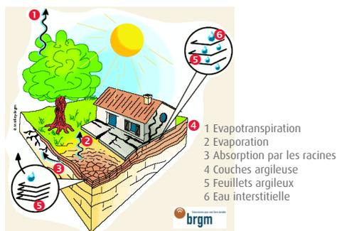
Un sol argileux change de volume selon son humidité comme le fait une éponge ; il gonfle avec l'humidité et se resserre avec la sécheresse, entraînant des tassements verticaux et horizontalement, des fissurations du sol.
