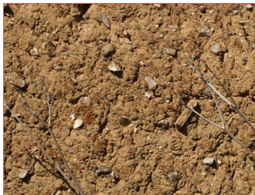
Couleur et texture de la bauge.
