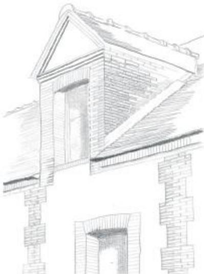
Lucarne, encadrement de baie et chaînes harpées en brique appareillée à Brezailles.
