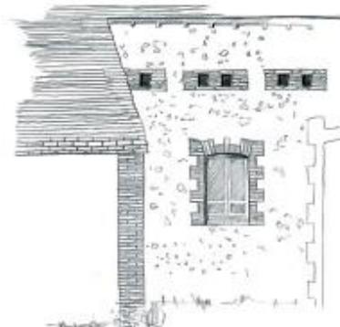
Maçonnerie mixte, enduit et brique :
