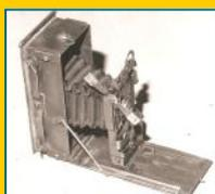
Appareil photo fabriqué au Front par G.Brillant avec de la douille d'obus, du tissu et des éléments d'horlogerie; muni d'un système de retard qui lui permettait de figurer sur les photos .
