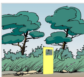
Exemple de balisage jaune signalant le transport souterrain de gaz.
