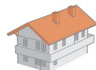
**Renforcer le toit.** Le renforcement du toit et la mise en œuvre de crochets tempête, d'assemblages vissés ou d'une sou-toiture protègent contre les forces générées par le vent. On revêtira la face inférieure des avant-toits.
