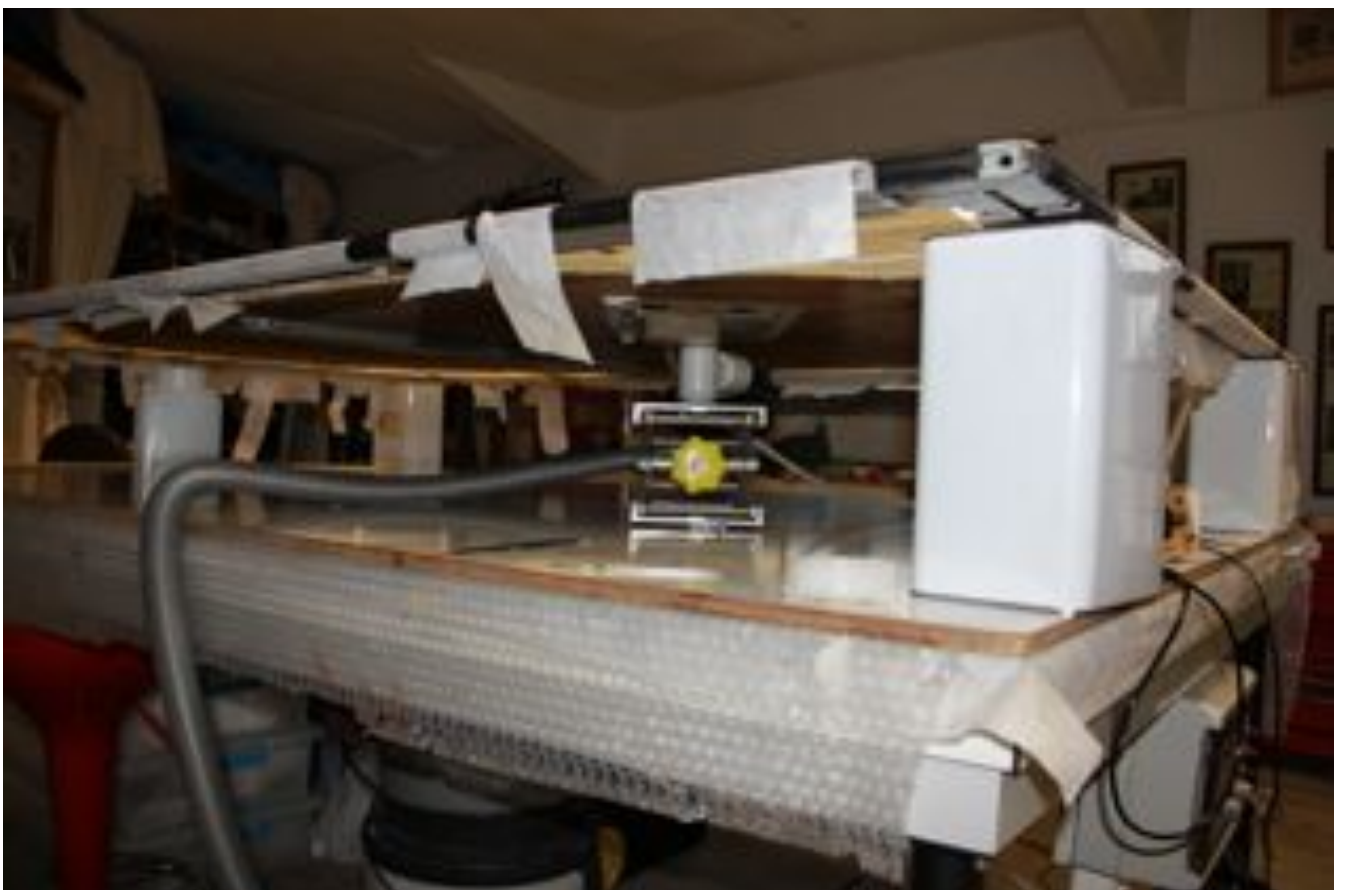
Refixage localis  des  l ments de couche picturale en soul vement sur micro-table basse pression.
