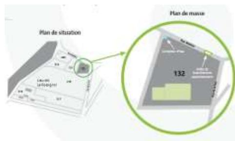
L'emplacement souhaité du compteur, en limite de propriété, doit être indiqué sur le plan de masse. **Le choix définitif de l'emplacement du regard à compteur est réservé à notre service.**
