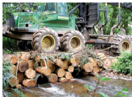
Rondins et tubes PEHD utilisés actuellement dans le secteur, sources images : espaces naturels
