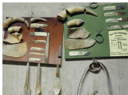
Etape de fabrication des peignes en corne à l'Aiguillon
