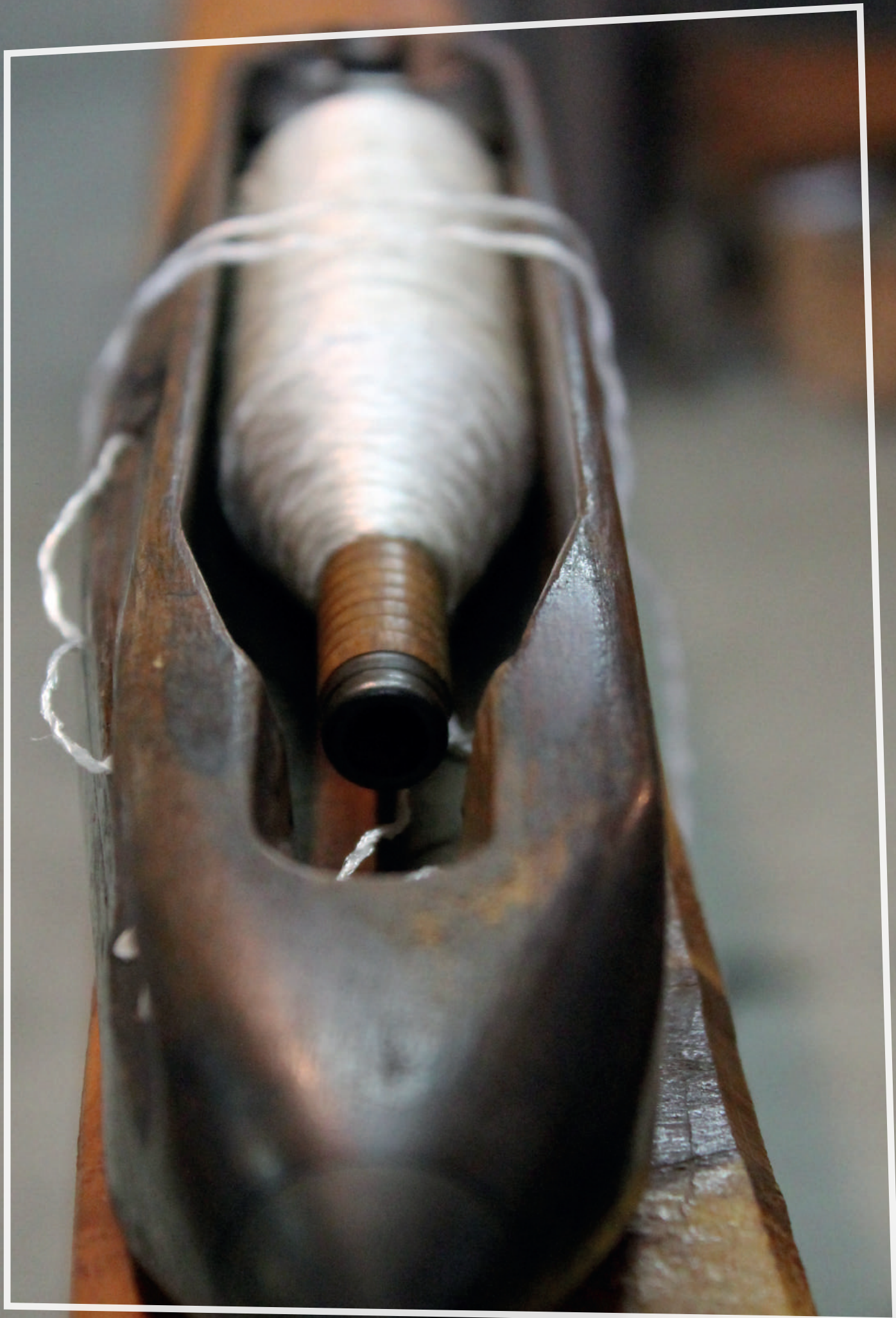
Navette volante utilisée avec les métiers à tisser, Musée du textile et du peigne en corne, Lavelanet © CCPO
