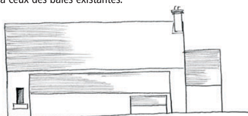
La façade nord n'est pratiquement pas ouverte. Des annexes se sont implantées sur cette façade, renforçant ainsi son isolation thermique.
