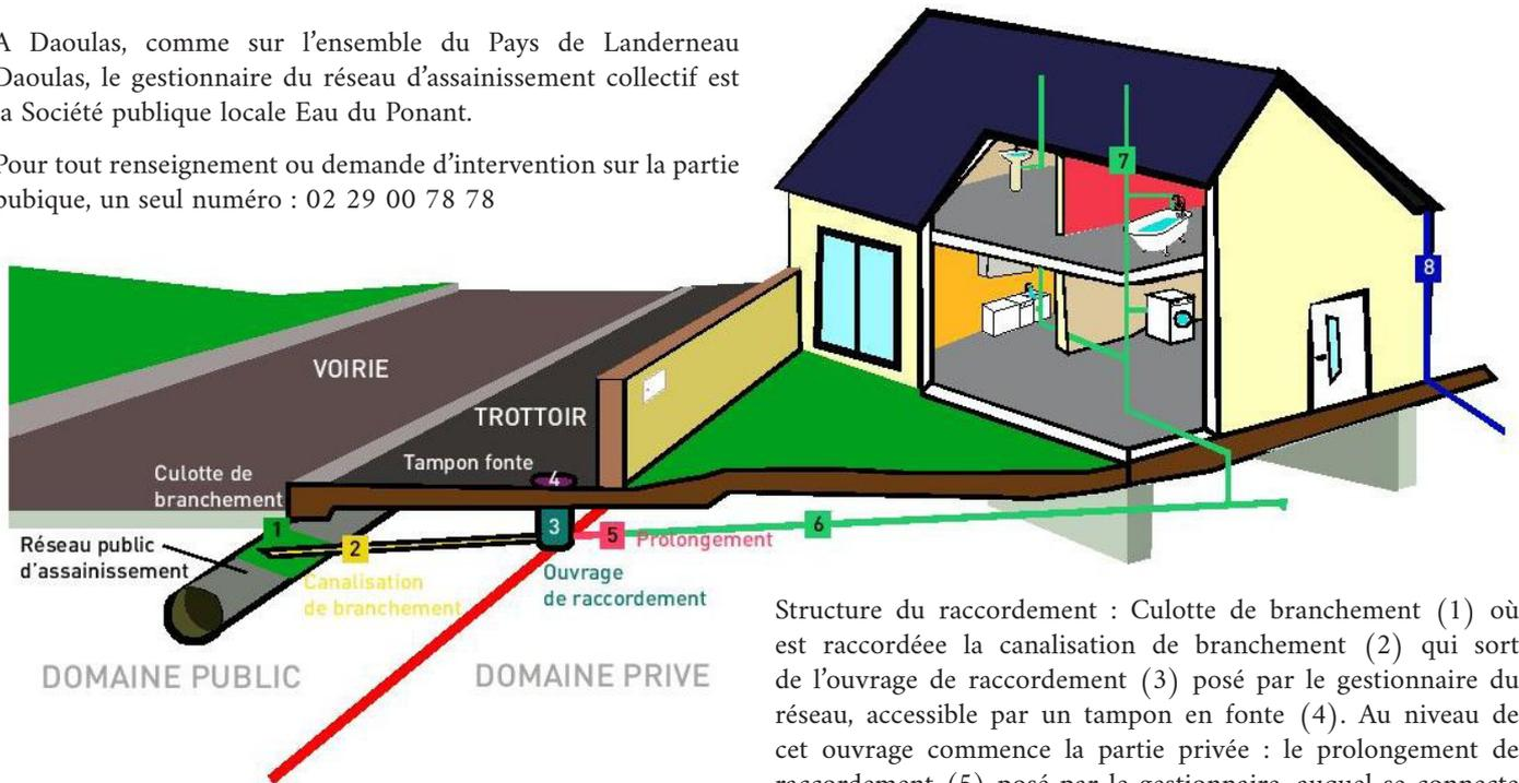
Structure du raccordement : Culotte de branchement (1) où est raccordée la canalisation de branchement (2) qui sort de l'ouvrage de raccordement (3) posé par le gestionnaire du réseau, accessible par un tampon en fonte (4). Au niveau de cet ouvrage commence la partie privée : le prolongement de raccordement (5) posé par le gestionnaire, auquel se connecte la canalisation de raccordement (6) posée par le propriétaire, disposant d'une aération sur la colonne de chute (7).
