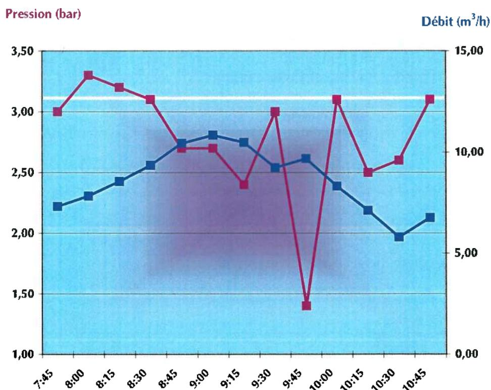
La chute de pression observée à 9h45 n'est pas justifiée par une forte augmentation de la consommation et peut correspondre à un puisage mécanique sur le réseau (surpresseur,...).
