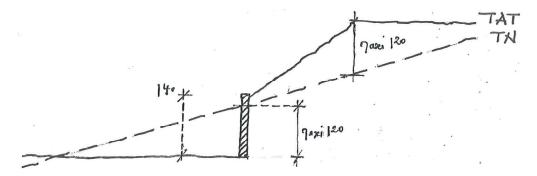
Sur terrain plat (pente ≤ 5 %), les mouvements de sol d'une hauteur supérieure à 0,60 m résultant d'une mise en sous-sol partielle du garage sont interdits.
