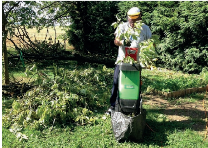
Les broyeurs électriques sont plus adaptés aux branches de diamètre faible, inférieur à 2-3 cm.
