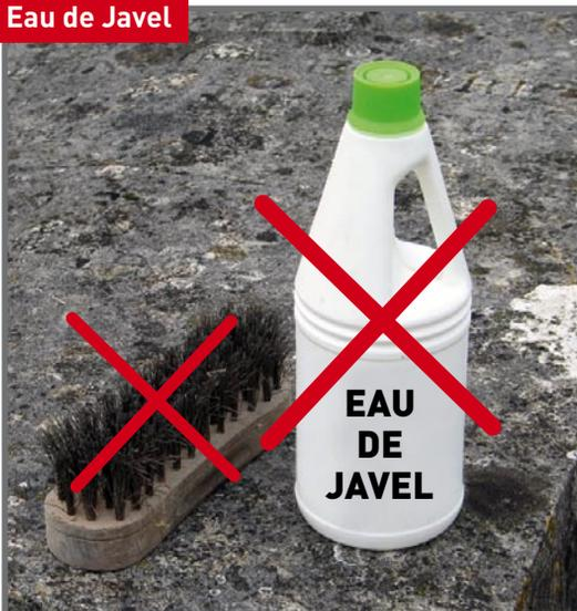
L'**eau de Javel** (ou hypochlorite de sodium) permet d'obtenir un effet immédiat mais attaque pierre et métaux. Elle entraîne la formation de chlorure de sodium (sel de cuisine). Ce sel reste dans la pierre, aucun rinçage ne peut l'en faire sortir. Lorsqu'il cristallise, il entraîne une dégradation irrémédiable du matériau.
