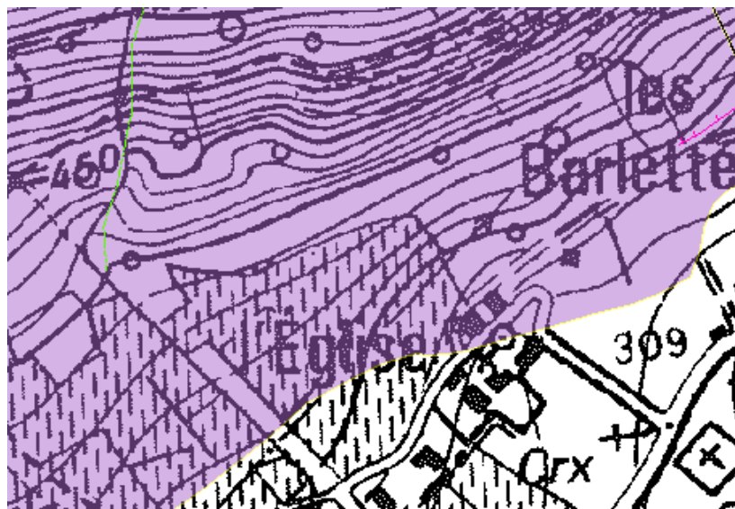
Figure 50: carte des aléas chutes de blocs au droit de l'Eglise
