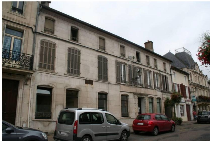
Figure 42 : Le rôle de représentation alloué à la façade sur rue induit souvent la présence d'une ornementation simple et élégante. Ici ce sont un bandeau, une corniche et des garde-corps en fer forgé
