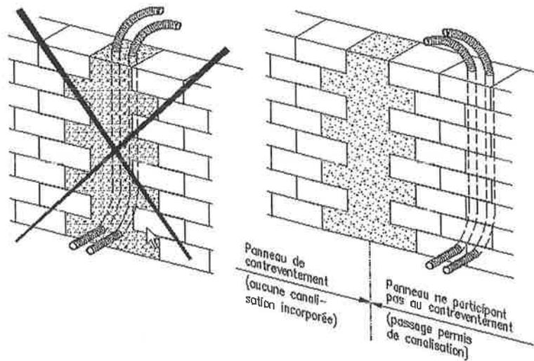
Percements et saignées : interdits dans les murs de contreventement
