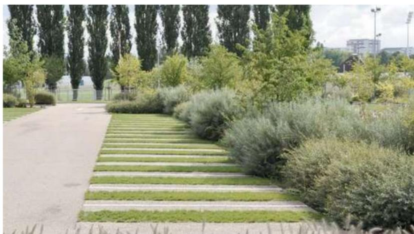
Places de stationnement en dalles engazonnées avec des bandes de béton drainant aux emplacements des roues
