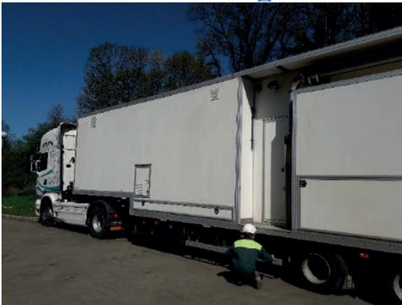
Unité mobile de déshydratation des boues à la step de Lanvollon pendant le 1<sup>er</sup> confinement, pour déshydratation pour envoi en compostage.
