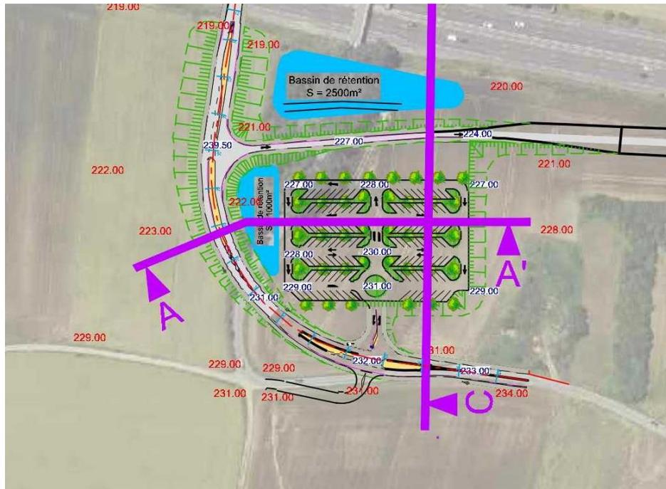
La plateforme du parking de covoiturage est aménagée en remblais et représente une superficie de 6 100m<sup>2</sup> (94m de long x 65m de large).
