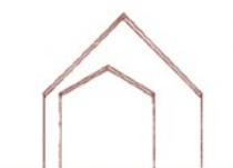
pignons emboîtés de pentes inégales
