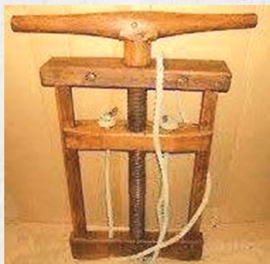
Bâtissoir, outil de tonnelier servant à retenir les douves avec lesquelles on fabrique les tonneaux.
