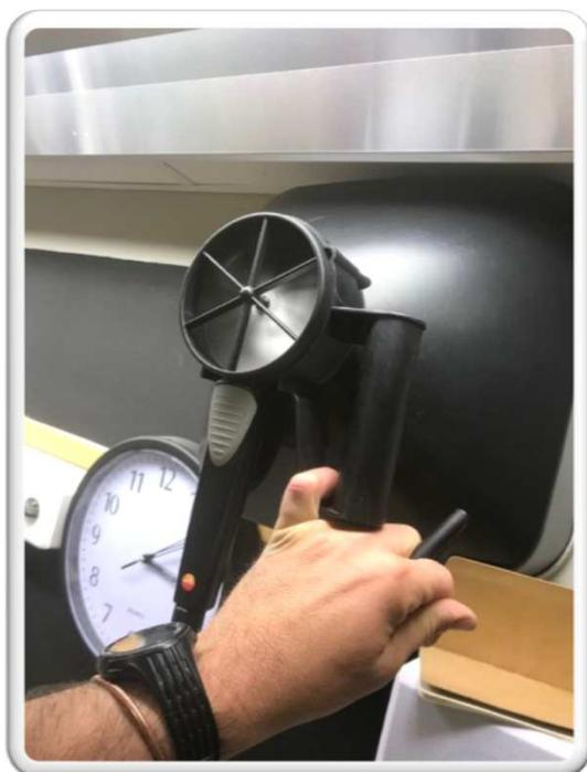
*Mesure des débits de ventilation mécanique par un cône Kimo*
