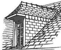
Lucarne charpentée à croupe avec surplomb
