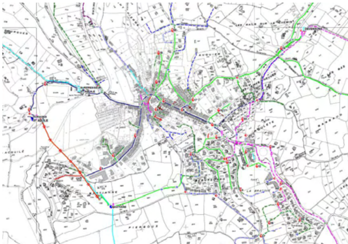
Extrait du réseau d'alimentation en eau potable
