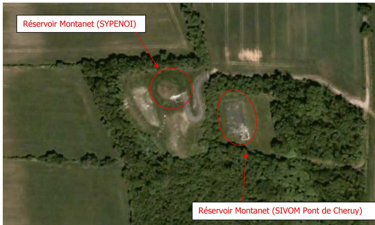
Le réservoir du SYPENOI présente l'avantage d'être situé 9 mètres plus haut que celui du SIVOM, mais l'inconvénient d'avoir une capacité de 1 000 m<sup>3</sup> inférieure à celui du SIVOM.
