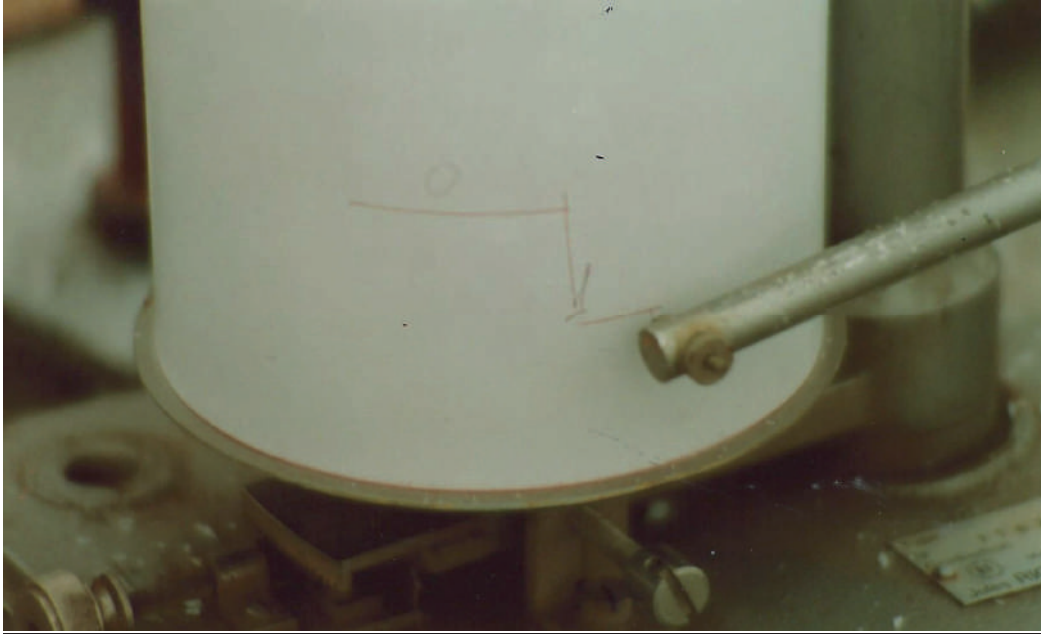
Appareil de mesure de la charge des ouvrages d'art (ici route de Grièges)
