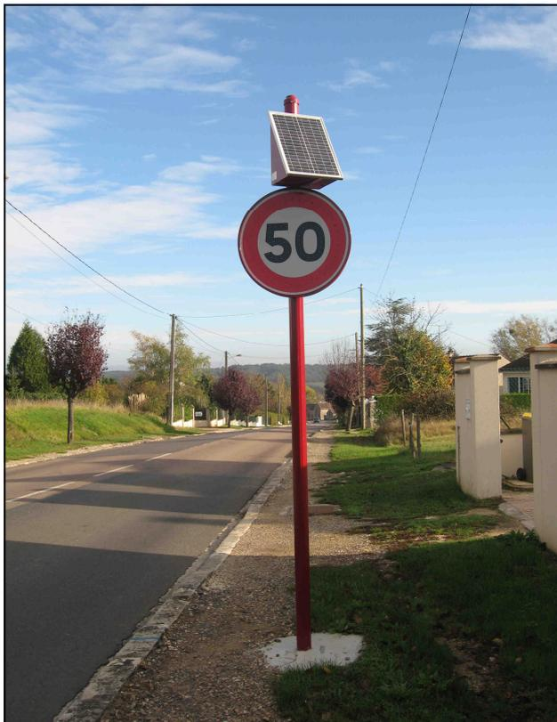
Des panneaux « 50km/heure » lumineux (à énergie solaire et radar incorporé) sont désormais placés aux 4 entrées principales de la commune : rue Henri Durocher, rue Pasteur, rue du Général de Gaulle et rue des Percherons. Ces panneaux clignotants se déclenchent si la vitesse du véhicule est supérieure à 50km/heure qui est la vitesse maximum autorisée en agglomération.
