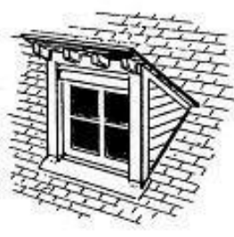
lucarne retroussée, ou demoiselle ; c'est aussi le vrai chien-assis
