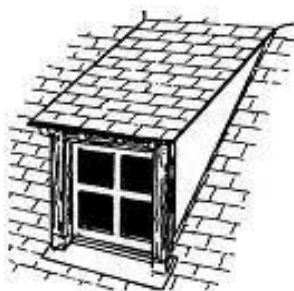
lucarne rampante ou en chien couché
