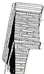
Souche de cheminée en brique rouge avec des cordons
