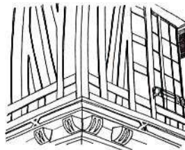
Mur en enduit ciment décoré de faux pans de bois peints
