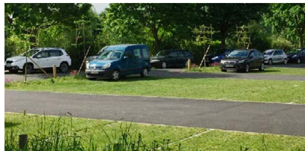
Parking perméable en caillbotis laissant la végétation s'installer
