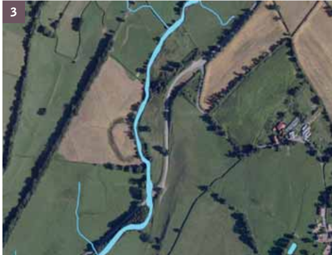
3 Conserver un espace de mobilité permet de ne pas gêner les possibles réajustements morphologiques du cours d'eau. Ici : espace de mobilité du Sornin à St Edmond avec son méandre abandonné et recréable par la rivière
