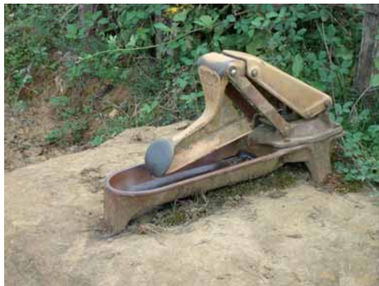
Pompe montée sur dalle béton
