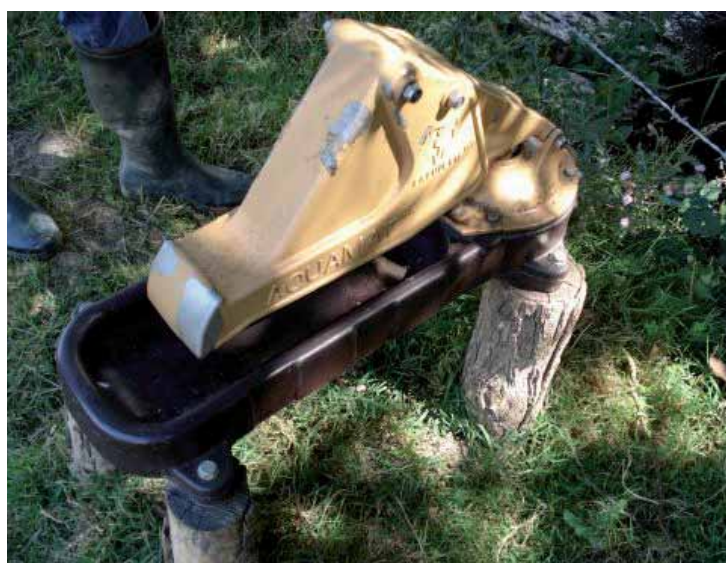
Pompe montée sur pieux en bois
