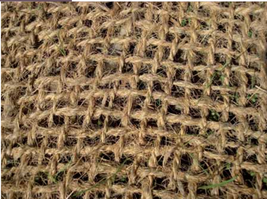
Treillis en coco de géotextile biodégradable tissé vue de près
