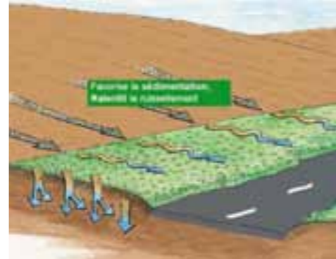
Schéma de principe du fonctionnement d'une bande enherbée
